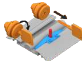
Fechadura travada giro de 45° sentido horário chave na posição vertical pode ser retirada da fechadura
